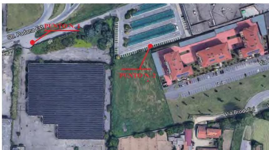
**Punto n. 1:** lato Nord, in prossimità del cancello di ingresso del capannone esistente. Il fonometro è stato posizionato in prossimità dell'ingresso carraio del capannone. Il fonometro è stato inoltre posizionato ad un'altezza di circa 1,50 metri ed a una distanza di circa 2 metri da ogni ostacolo. In questo punto è stato effettuato un rilevamento tra le ore 14.17 e le ore 14.26 del 20/10/2017. Le misure sono state influenzate dal traffico veicolare presente nella zona.
